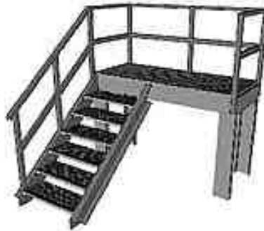
Einfache Treppe mit Podest und einseitigem Geländer
