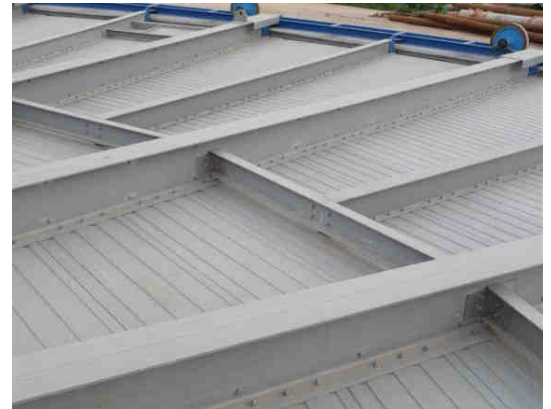
Flachabdeckung mit Laufsteg (drehbar auf Rollen gelagert): Max Durchmesser: 20 m Gewicht: ca. 22 kg/m 2 Traggewicht: walkable (ca. 100 kg/m 2 )
