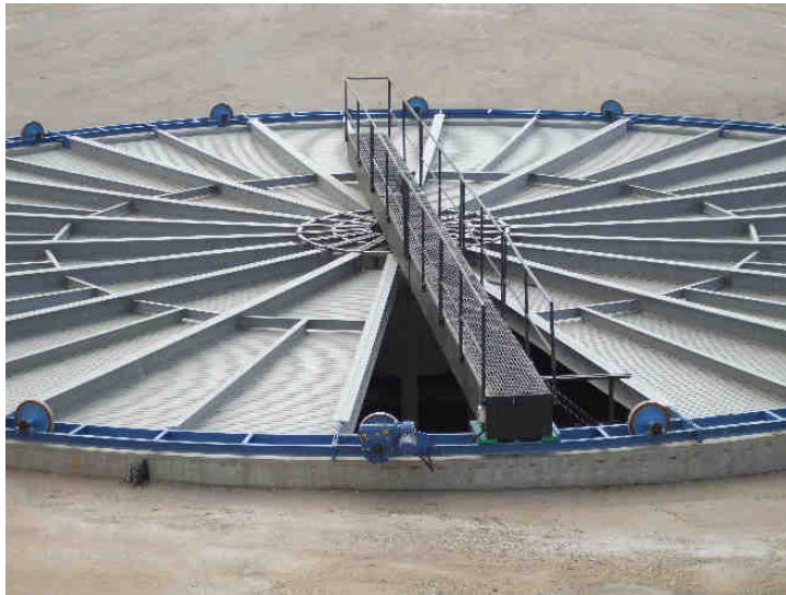
Flachabdeckung mit Laufsteg (drehbar auf Rollen gelagert): Max Durchmesser: 20 m Gewicht: ca. 22 kg/m 2 Traggewicht: walkable (ca. 100 kg/m 2 )
